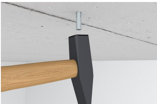
3. Dübel bündig einschlagen
