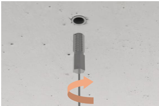
5. Drahtseile in die Einschlagdübel eindrehen
